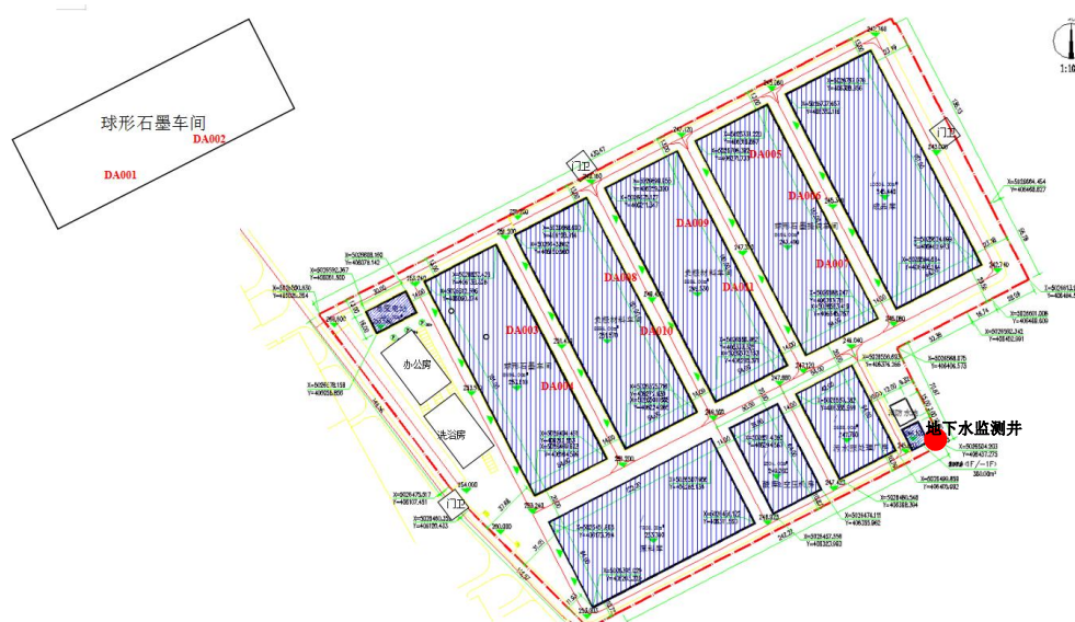
图6.2-6 地下水跟踪监测井
